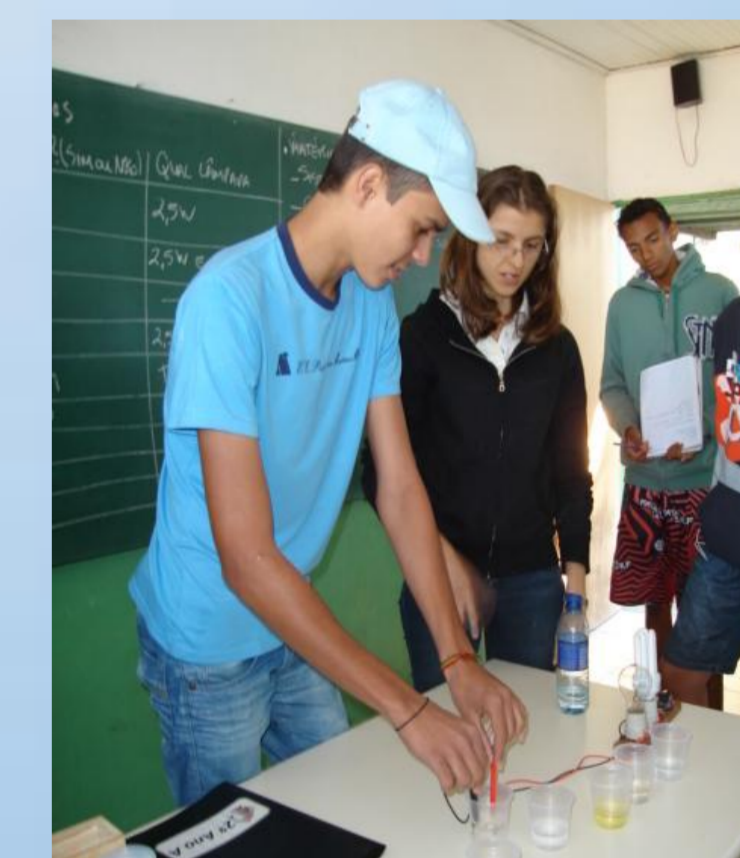
Aferição da condutibilidade elétrica da água.
