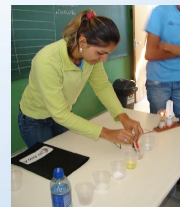
Aferição da condução de eletricidade de soda cáustica com excesso de umidade.
